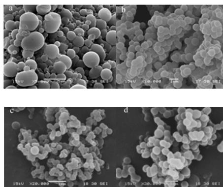
Figure 6. The SEM micrograph of PSAN/Stab (a)PSAN/Stab0 (b) PSAN/Stab5 (c) PSAN/Stab10 (d) PSAN/Stab15
